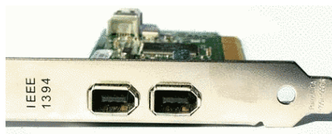
Obrázek 4.3: FireWire se 4 a 6 signálními okruhy 3
