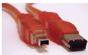
Obrázek 4.3: FireWire se 4 a 6 signálními okruhy 3
