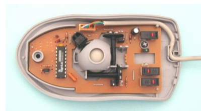
Obrázek 10.4: Princip mechanické myši
