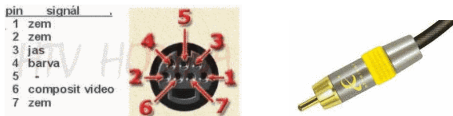
Obrázek 4.17: 7pinový S-Video a Composite Video jack 12
